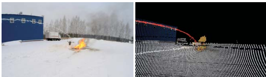
Рис. 2. Фотопанорама натуральных испытаний (слева) и 3D-модель с распознанным очагом возгорания и струей огнетушащего состава (справа)
