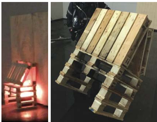
Рис. 5. Модель очага и результат тушения роботизированной установкой пожаротушения
